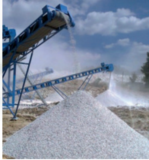
Şekil 5.13 - Mermer Ocaklarından Çıkan Katı Mermer Artıklarının Kum, Çakıl ve Mıcır Haline Dönüştürülmesine Dair Görsel
