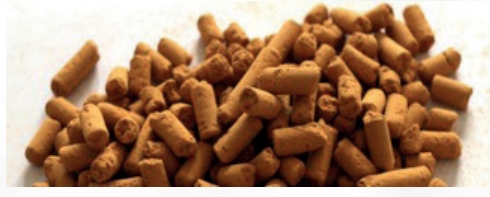
Şekil 5.18 - Endüstriyel Üretim Sonucu Elde Edilen Demir Oksit ( FE_2O_3 ) 134
